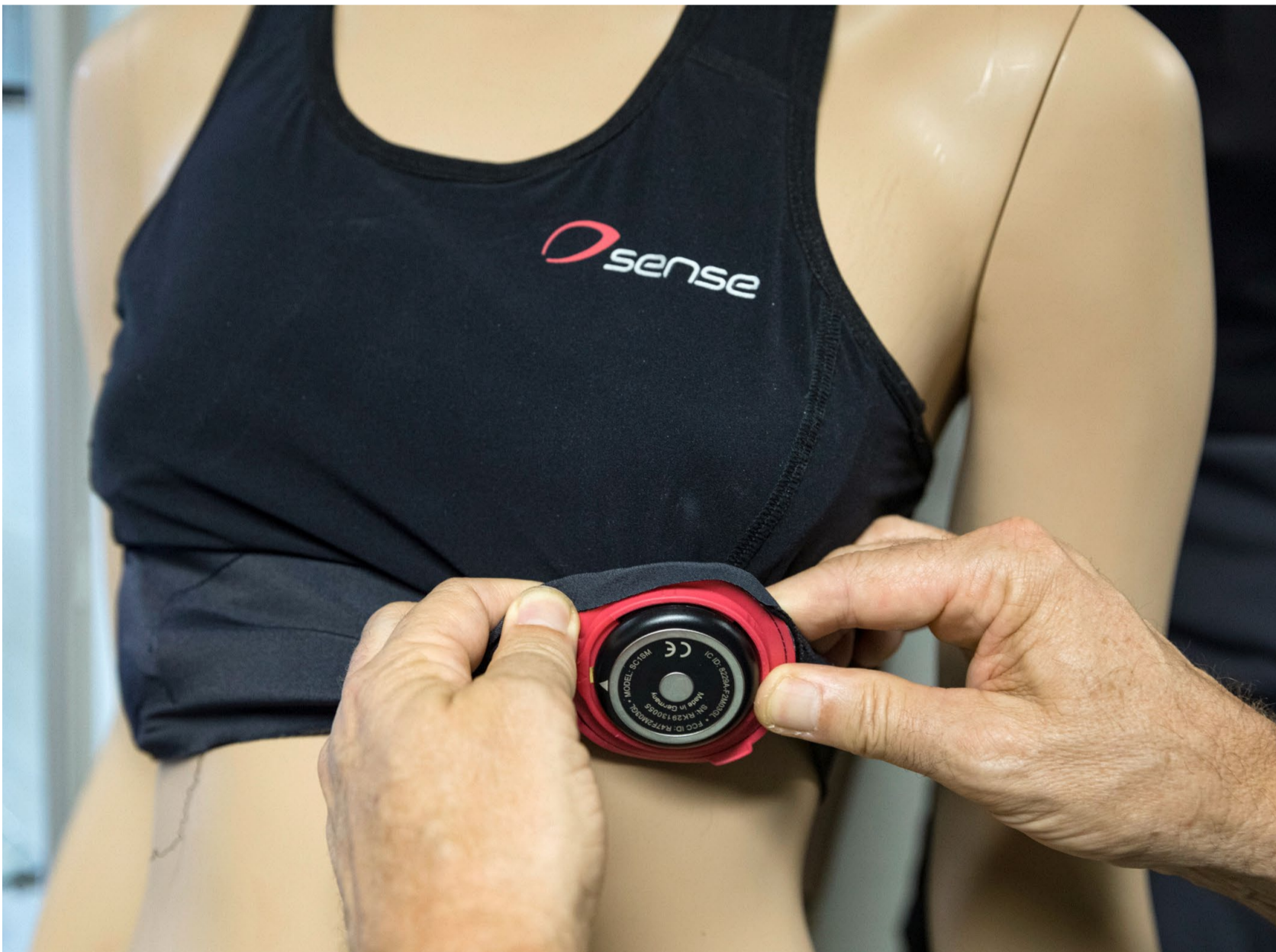
Kooperative Sensoren: Mittels der proprietären Trockenelektrode-Technologie werden Vitaldaten wie EKG und Atmungsfrequenz mit hoher Signalqualität gemessen.
